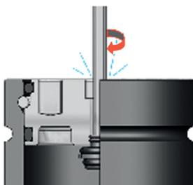
2. Um das Ventil zu lösen, benutzen Sie einen 3 mm Inbusschlüssel. Drehen Sie diesen nach rechts bis das Gas entweicht (1- 2 Umdrehungen).
