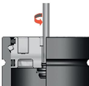
3. Sobald die Gasdruckfeder entladen ist, drehen Sie das Ventil nach links bis die Ausgangsposition erreicht ist. Die Gasdruckfeder ist fertig zum Befüllen.
