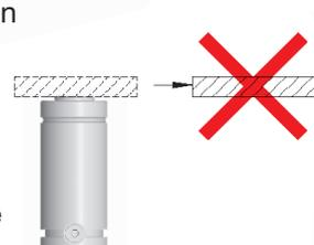
Die Gasdruckfeder muss senkrecht zu der Kontaktoberfläche arbeiten. Seitenkräfte reduzieren die Lebensdauer der Gasdruckfeder.
