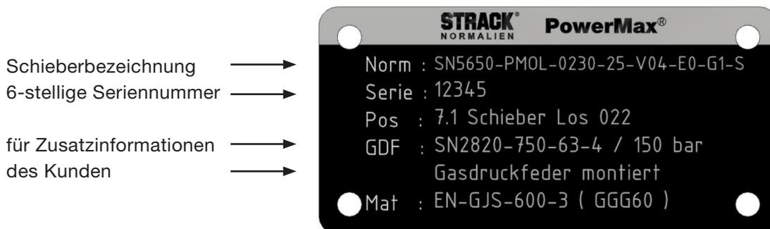
Die Seriennummer bezieht sich auf alle Schieber eines Auftrages und ist von Auftrag zu Auftrag unterschiedlich. Die PowerMax-Schieber wurden im Hause STRACK eingestellt. Hierzu wurden die gehärteten Stahlgleitleisten auf das entsprechende Maß geschliffen. Die dazugehörigen Schrauben wurden mit Z9093 Schraubensicherungskleber zusätzlich gesichert.
