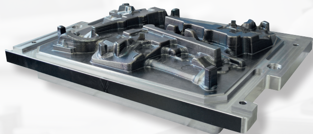
Formplatte mit vorgearbeiteter 3D-Fräskontur
