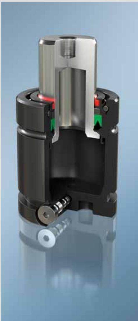
währleistet die Reinigungslippe das Herausickern von überflüssigem Schmiermittel aus dem Gasdruckfederinneren. Diese Vorrichtung kann in VDI/ISO und MICRO Gasfederreihen eingebaut werden, um eine längere Lebensdauer zu gewährleisten.
