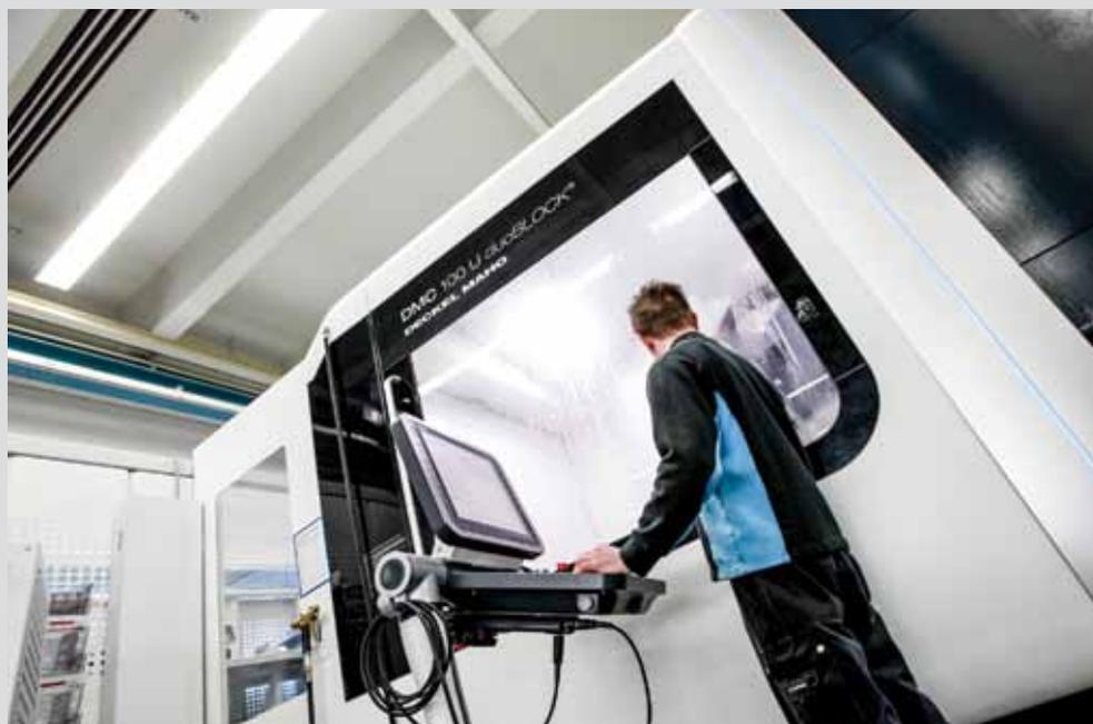
kurze Nebenzeiten realisiert werden. Die 5-Achs-Simultanfräse mit NC-Rundtisch und NC-gesteuerter B-Achse verfügt über einen schnellen Drehpalettenwechsler für hauptzeitparalleles Rüsten bei der Bearbeitung von Klein- bis Großserien. Die manuelle Eingabe über einen Bildschirmarbeitsplatz sowie beste Zugänglichkeit zum Arbeitsraum, Rüstplatz und Wartungseinrichtungen er-
