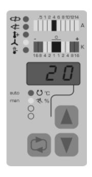
Dans ce mode, il est possible de faire fonctionner une zone dechauffage en mode manuel pour effectuer des essais. Le voyant d'écart de régulation (2) réagit en fonction de la valeur de consigne préréglée. Lorsque les valeurs limites de température sont dépassées, les sorties correspondantes réagissent. Si la température est > 5 K à la valeur limite de température surélevée, le relais de charge supplémentaire s'ouvre.
