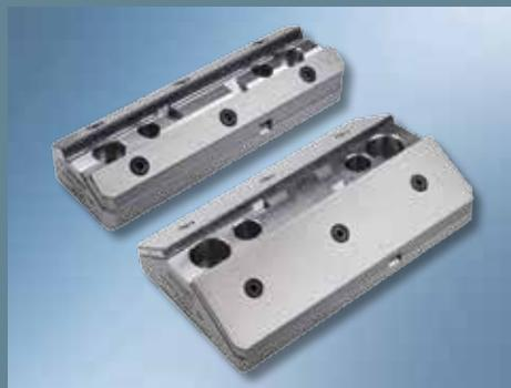
Bei Verschleiß muss nun nicht mehr das komplette Gleitstück ausgetauscht werden, sondern nur noch die zwei Sintermetallgleitführungsleisten, was zu erheblichen Kosteneinsparungen führt. Weiterhin ist in verschiedenen Tests in der Automobilindustrie festgestellt worden, dass die Standzeit von Sintermetall um ein vielfaches höher ist als die von Bronze mit Festschmierstoff.
