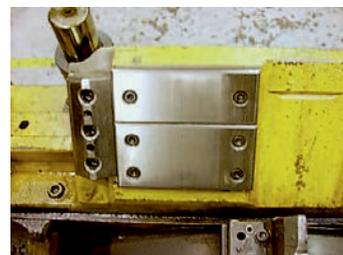
■ SNS-Sintermetall und Gegenlager nach 187.000 Hüben
