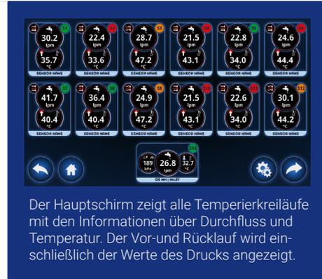
Der Hauptschirm zeigt alle Temperierkreisläufe mit den Informationen über Durchfluss und Temperatur. Der Vor- und Rücklauf wird einschließlich der Werte des Drucks angezeigt.
