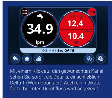
Mit einem Klick auf den gewünschten Kanal sehen Sie sofort die Details, einschließlich Delta T (Wärmetransfer). Auch ein Indikator für turbulenten Durchfluss wird angezeigt.
