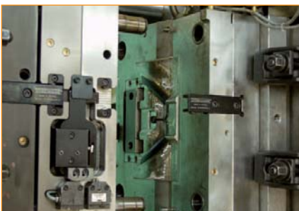
Während das Spritzgießteil in der ruhenden Trennebene auskühlt, wird zeitgleich das Produkt in der arbeitenden Trennebene ausgeworfen.
