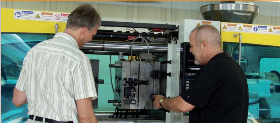
■ Doppelter Ausstoss: Geschäftsführer Udo Werner (rechts) präsentiert Ludger Müller, Technischer Leiter von STRACK NORMA, ein Tandemwerkzeug im Spritzgießprozess.
