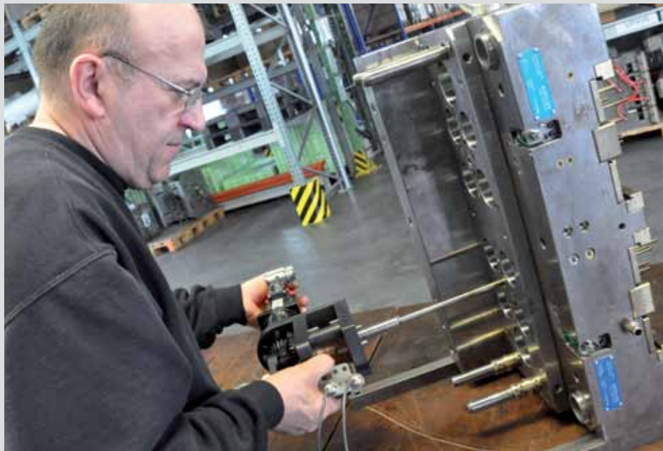
Bei der Firma Schnitzler setzt der Werkzeugbau schon länger die elektrische Ausschraubeinheit ein.
