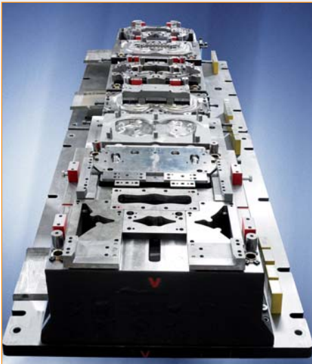
Rekordzeit: Das 22 Tonnen schwere Stanzwerkzeug wurde von der Firma Sänger & Medic konstruiert und produziert.
