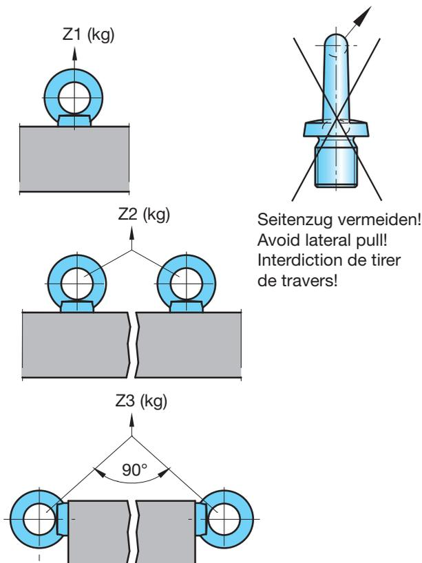
Les anneaux vissables de levage selon cette norme servent surtout du moyen de suspension de la charge pour la fixation durable auprès des éléments comme des moteurs, des armoires électriques, des engrenages et cetera, pour leur transport.
