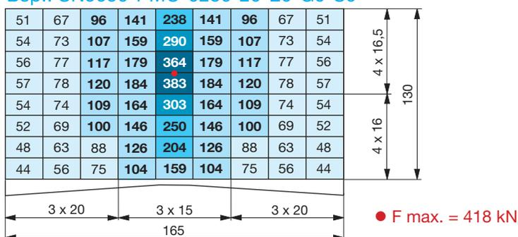
Hieraus ist deutlich die maximale Kraft außerhalb des Wirkzentrums für die X bzw. Y Achse abzulesen. Mögliche zukünftige Positionsänderungen sollten im Vorfeld berücksichtigt werden um eine der Kraft entsprechende Schiebergröße zu wählen.
