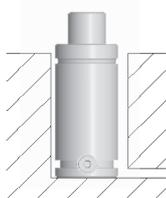
Schützen Sie die Gasdruckfeder vor direktem Kontakt mit flüssiger Verschmutzung: Schmierstoffe, Reinigungsmittel usw.
