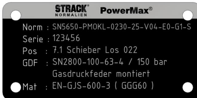
Die Seriennummer bezieht sich auf alle Schieber eines Auftrages und ist von Auftrag zu Auftrag unterschiedlich. Die PowerMax-Schieber wurden im Hause STRACK eingestellt. Hierzu wurden die gehärteten Stahlgleitleisten auf das entsprechende Maß geschliffen. Die dazugehörigen Schrauben wurden mit Z9093 Schraubensicherungskleber zusätzlich gesichert.
