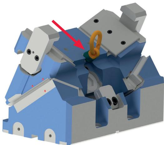
Durch die Positionsänderung der Sicherheitsringschraube können Schieberaufnahme und Schieberschlitten einfacher miteinander ins Werkzeug eingebaut werden.
