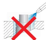
Schützen Sie die Gasdruckfeder vor mechanischen Schäden oder Schlägen, besonders die Kolbenstange. Jeglicher Defekt könnte einen Druckverlust hervorrufen.
