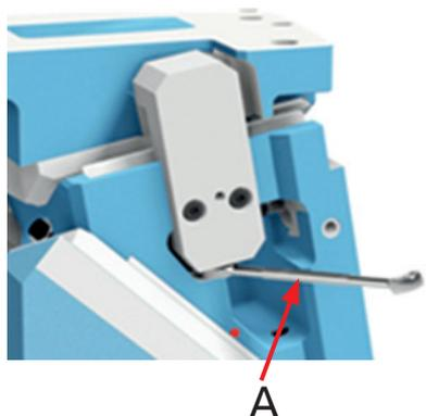
Fixieren Sie die Befestigungsschrauben der Einstellkeile und der Aktivrückzüge (B), anschließend kontern Sie den Aktivrückzug (A) und prüfen das Führungsspiel mit 0,01 mm Lehrenband. Um ein Verkippen des Treibers zu verhindern sollten beide Seiten gleich angezogen werden.
