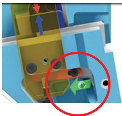
Nach Aufsetzen des Treibers auf den Schieberschlitten drücken Sie die Aktivrückzüge auf die Einsätze des Treibers und fixieren sie durch Verschieben des Einstellkeils in Pfeilrichtung.
