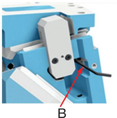
Stellen Sie die Schieberaufnahme mit dem Schieberschlitten auf die Kopfseite der Schieberaufnahme um einen festen Stand zu gewährleisten.
