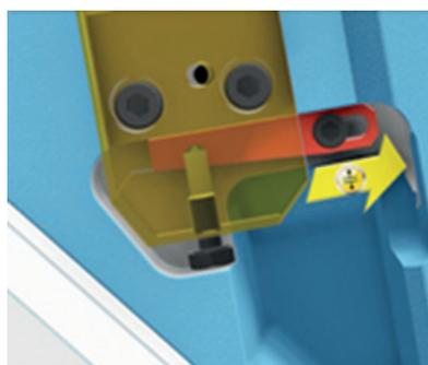
Ziehen Sie den Einstellkeil zurück und setzen Sie den Treiber auf das Prisma des Schieberschlittens.
