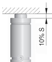
Eine nominelle Hubreserve von 10 % sollte vorgesehen sein, um irreparablen Schaden in der Gasdruckfeder und ernsthafte Sicherheitsgefährdungen zu vermeiden.
