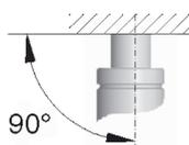
Die Gasdruckfeder muss senkrecht zu der Kontaktfläche arbeiten. Seitenkräfte reduzieren die Lebensdauer der Gasdruckfeder.
