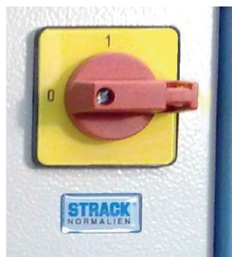
Der Hauptschalter ist abschließbar nach EN 81-80 ausgeführt. Vor Arbeiten am angeschlossenen Werkzeug oder am Regelgerät selbst muss das Gerät gegen Wiedereinschalten gesichert werden. Dies kann durch Ziehen des Netzsteckers und Sichern gegen Wiedereinstecken oder durch Sichern des Hauptschalters mit Schloss erfolgen.
