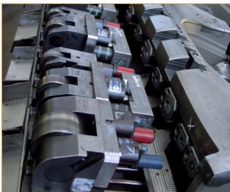
■ Über 30 Rollenschieber SN5620 sind zum Ausstanzen der Löcher der tiefgezogenen Seitenwand im Einsatz.
