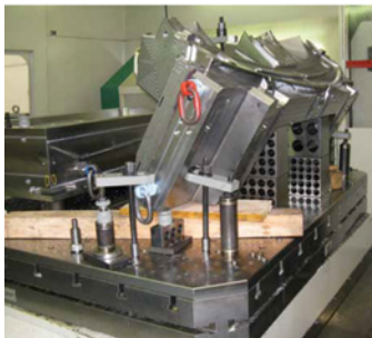
Konventionelle Spannung Rüstzeit 3-4 Stunden
